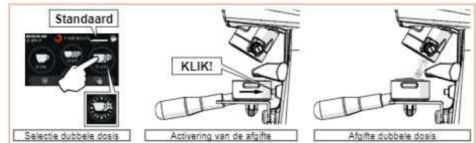
Fig. 12 - Afgifte dubbele dosis in modus "Standaard".
