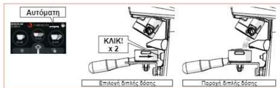
Εικ. 14 - Παροχή διπλής δόσης σε λειτουργία «Αυτόματη».
