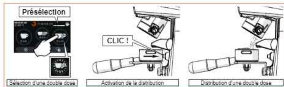
Fig. 15 - Exemple de distribution d'une double dose en mode « Présélection ».
