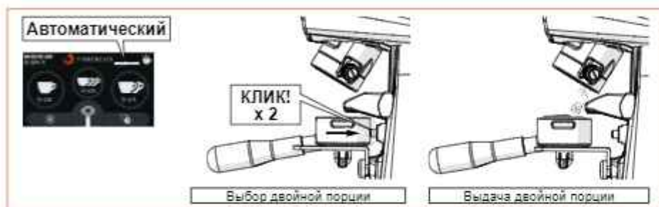
Рис. 14 - Выдача двойной порции в «Автоматическом» режиме.
