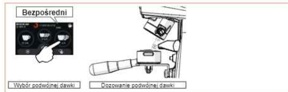
Rys. 13 - Dozowanie podwójnej dawki w trybie „Bezpośredni”.
