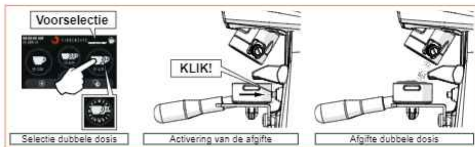
Fig. 15 - Voorbeeld van afgifte dubbele dosis toediening in de modus "Voorselectie".
