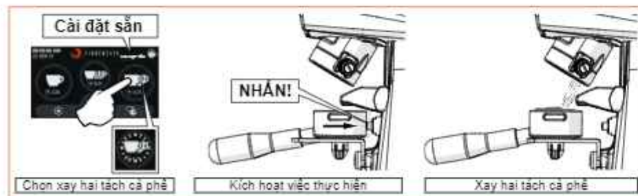
Hình 15 - Ví dụ về việc xay hai tách cà phê ở chế độ hoạt động "Cài đặt sẵn".
