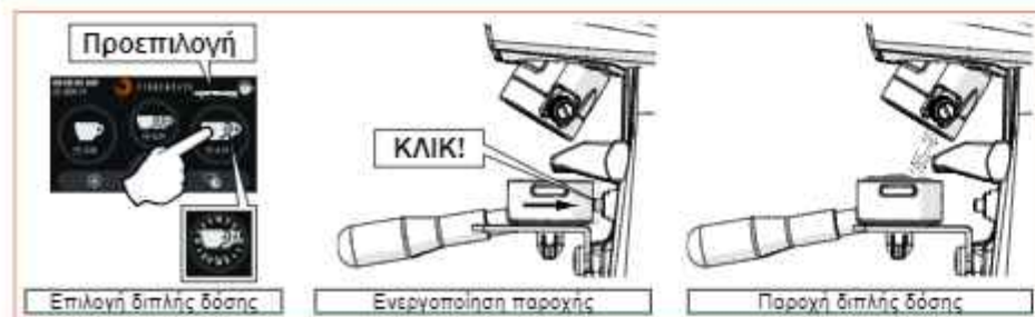
Εικ. 15 - Παράδειγμα παροχής διπλής δόσης σε λειτουργία «Προεπιλογή».
