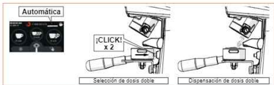
Fig. 14 - Dispensación de dosis doble en modo "Automático".
