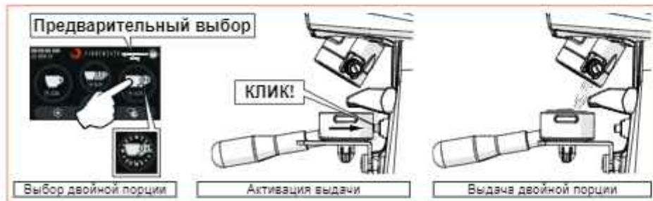
Рис. 15 - Пример выдачи двойной порции в режиме «Предварительный выбор».
