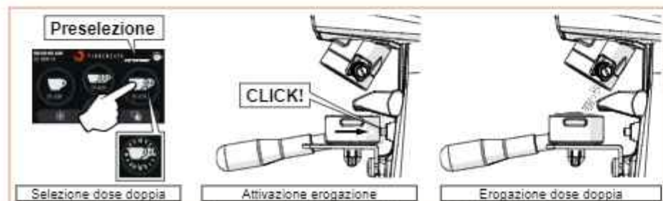
Fig. 15 - Esempio erogazione dose doppia in modalità "Preselezione".
