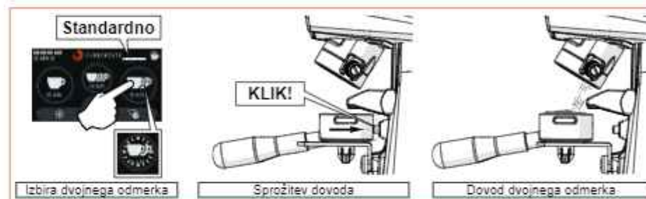
Sl. 12 - Dovod dvojnega odmerka v »Standardnem« načinu.
