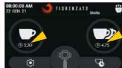
ГЛАВНЫЙ экран с отображаемым временем измельчения
