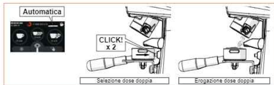
Fig. 14 - Erogazione dose doppia in modalità "Automatica".
