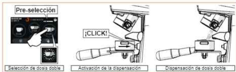
Fig. 15 - Ejemplo de dispensación de dosis doble en modo "Preselección".
