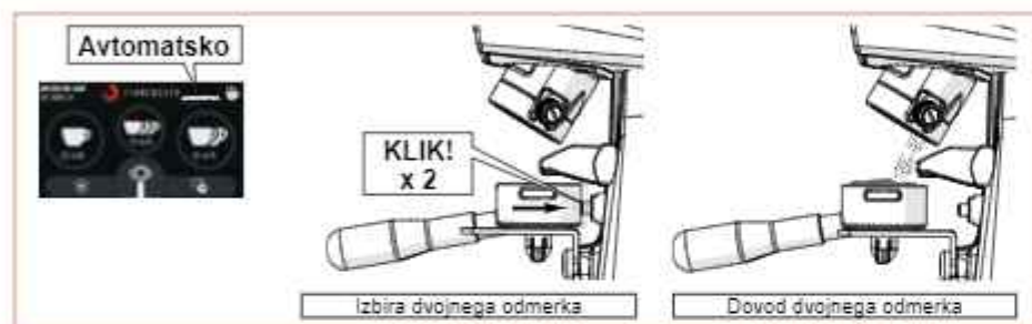
Sl. 14 - Dovod dvojnega odmerka v »Avtomatskem« načinu.
