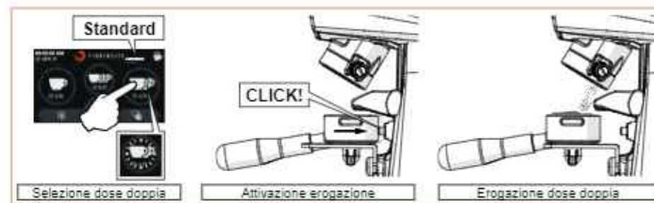
Fig. 12 - Erogazione dose doppia in modalità "Standard".
