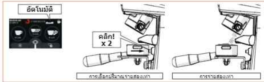
รูปที่ 14 - การจ่ายกาแฟสองเท่าในโหมด "อัตโนมัติ"
